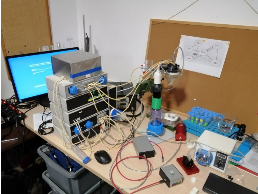
Fig. 3 – Sistem integrat cu detectie optica
